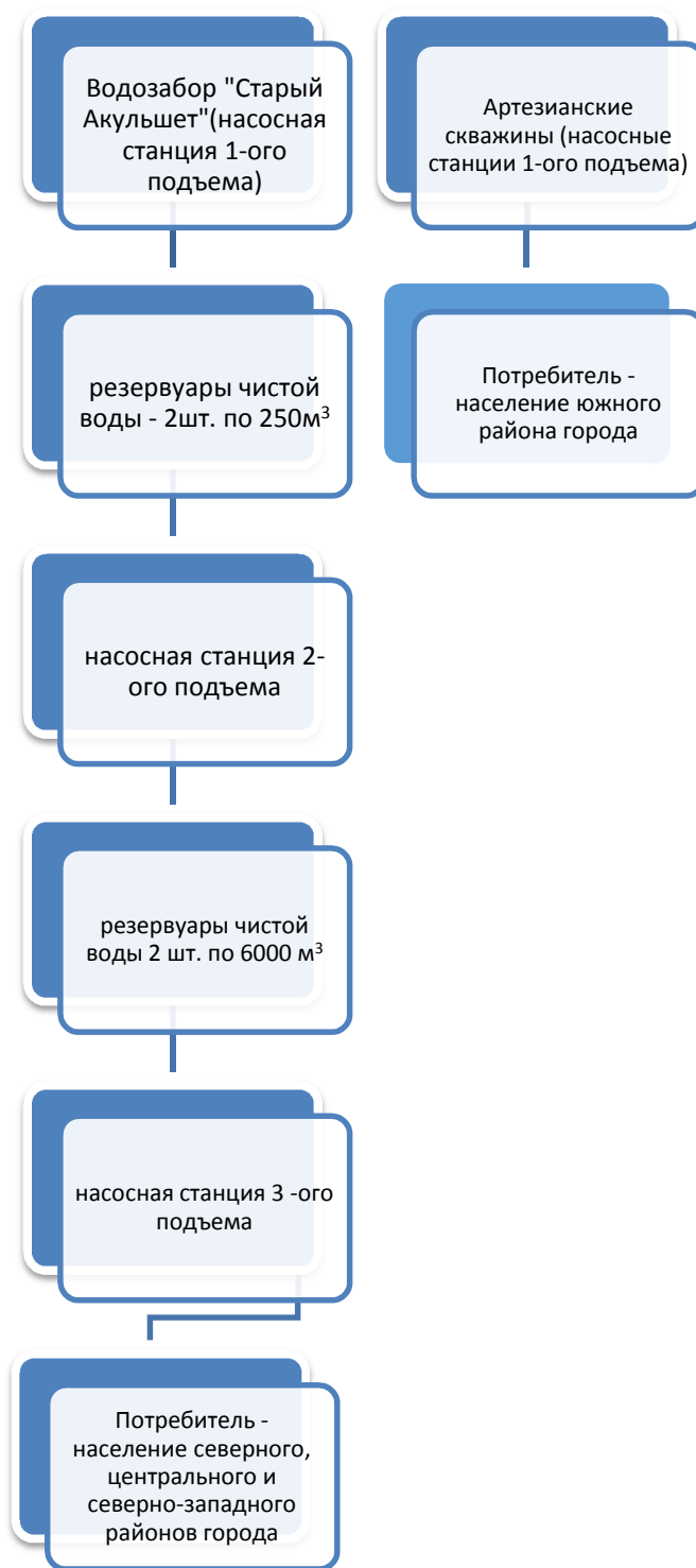
Рис.1.1.1. Структура централизованной системы водоснабжения
